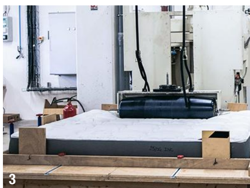
Test de maintien des performances des matériaux de l'âme (1). Test de durabilité du matelas : simulation d'une personne assise (2) et d'une personne couchée (3).
