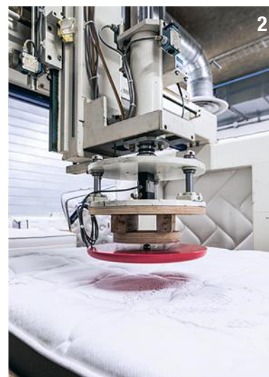
Test de maintien des performances des matériaux de l'âme (1). Test de durabilité du matelas : simulation d'une personne assise (2) et d'une personne couchée (3).
